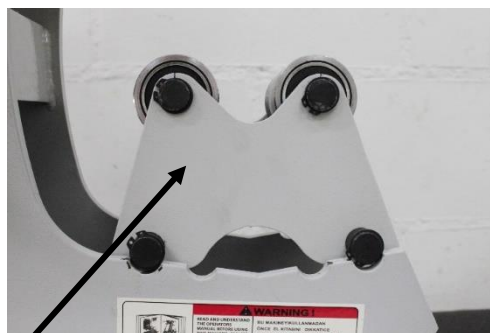
Base do rolete para corte de tubos de diâmetros 3" a 6"
